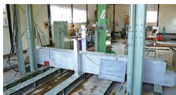
衝突荷重載荷試験
