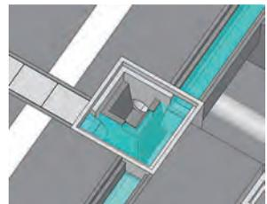
③大量の雨量の場合には、水量調節ブロック内に雨水が流れ貯留槽に貯留されます。
