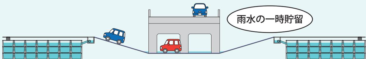
スコールボックスII型を道路両端に3段7列×4(84基)設置すると、貯留量135m<sup>3</sup>(一般的な小学校の25mプールの半分以上)の水量を確保可能
