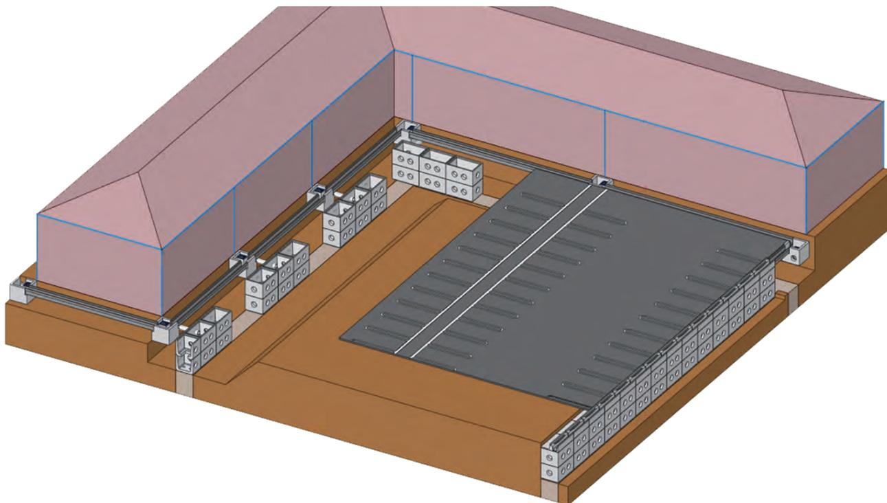
施設内に降った雨水を施設内の敷地で処理することにより、雨水の移動を最小限におさえ、雨が降った場所で貯留・浸透し、雨水の流出を抑制することができます。
